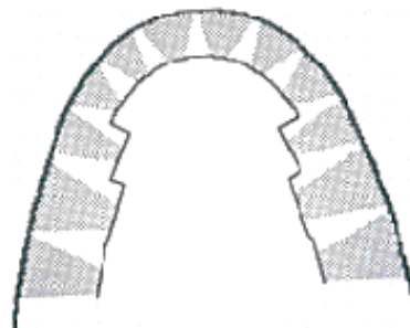
Рис. 37. Форма идеальной (заключительной) дуги, вычисленная с помощью программы DALI
