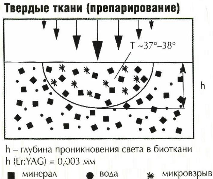
Рис. 36. Механизм препарирования ткани зуба излучением эрбиевого лазера
