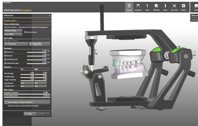
Рис. 31. Моделирование коронки с учетом данных аксиографии
