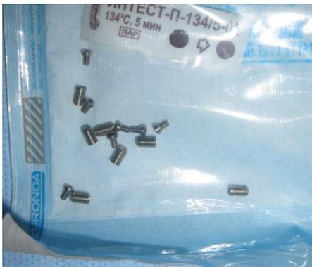
Рисунок 1. Дентальный имплантат фирмы ООО Верлайн, 3 x 5 мм из титана GRADE4 с пассивной резьбой и гладкой поверхностью
