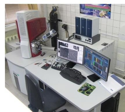
Рисунок 4. Сканирующий электронный микроскоп высокого разрешения MIRA3
