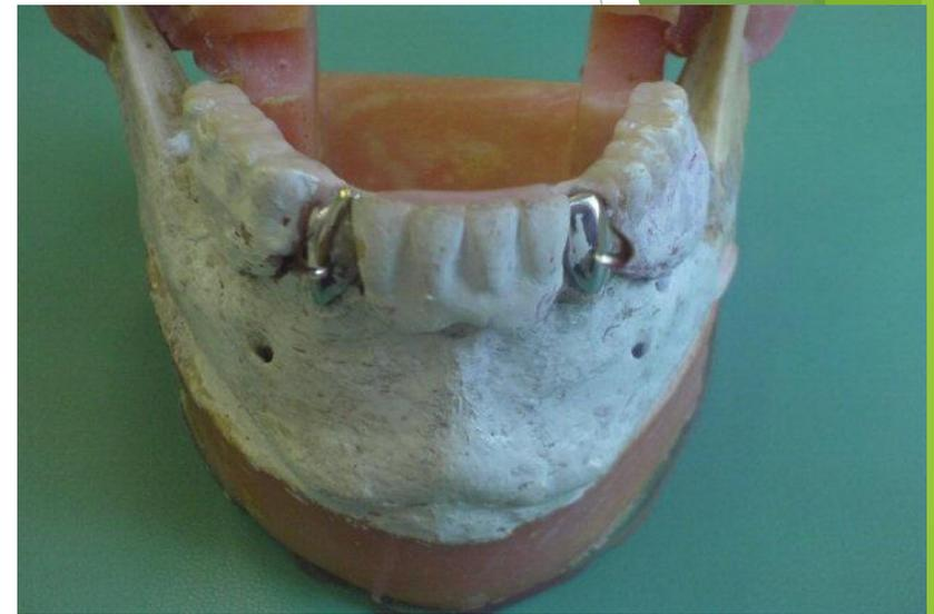
Во всех вариантах нижняя челюсть со съемными протезами нагружалась автономно, на специальном стенде в нагрузочном устройстве, представляющем собой рычажный механизм, оборудованный датчиком усилия.
