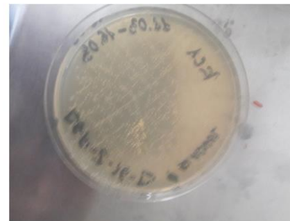
Рис. 18 – Посев на среду КСА смыва, полученного с водовоздушного пистолета, после инкубации при температуре 30-35 градусов Цельсия.
