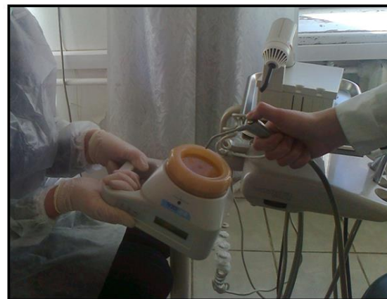
Рис. 16 – Забор воздуха из водовоздушного пистолета прибором Air Ideal.
