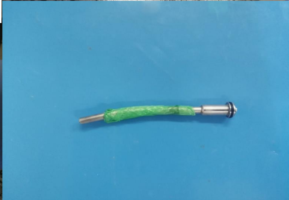
Рис. 20 - Процесс упаковки носика водовоздушного пистолета термопленкой.
