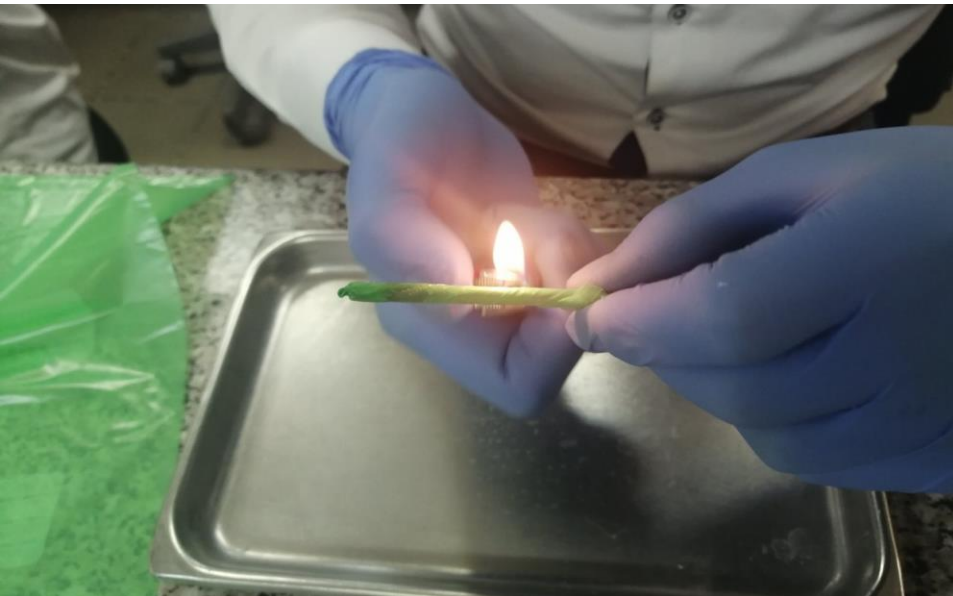
Рис. 20 - Процесс упаковки носика водовоздушного пистолета термопленкой.
