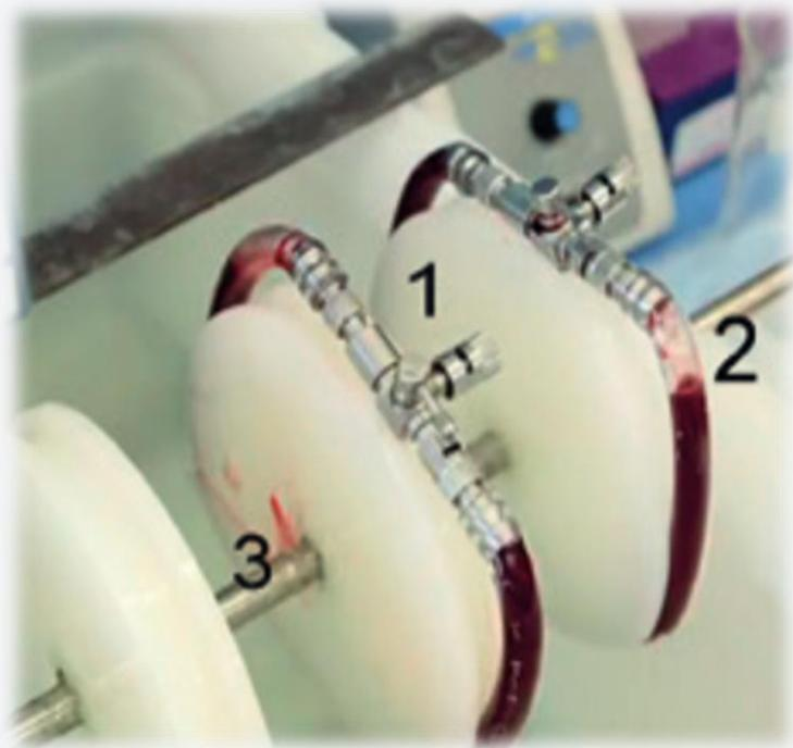
Петля Чандлера состоит из замкнутой трубки, частично заполненной воздухом, располагаемой в плоскости, перпендикулярной оси вращения основания, соединенного с ротором .
