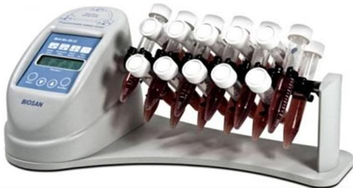
Объект исследования (образец – часть изделия медицинского назначения, имеющий непосредственный контакт с кровью) помещают в пробирку, после чего ее заполняют цельной кровью донора с введенным в ее состав антикоагулянтом.
