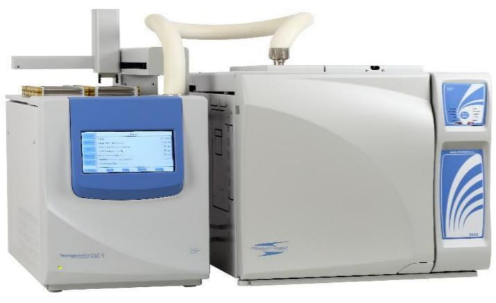
газовый хроматограф «Кристалл 5000», оснащенный двумя пламенно-ионизационными детекторами и двустадийным термодесорбером
