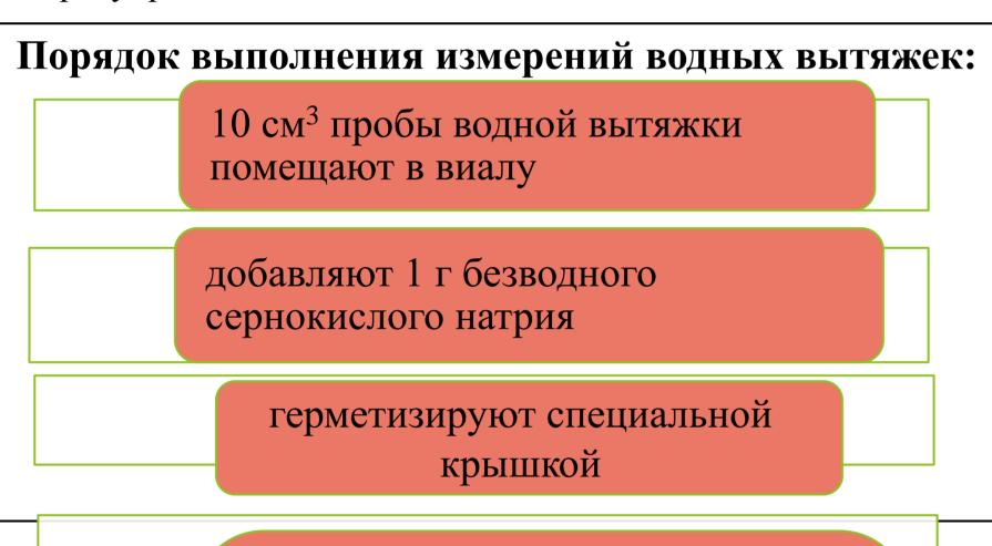
виалу помещают в термостат дозатора равновесного пара
