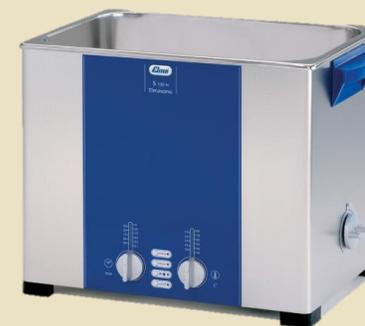
Помещают в ультразвуковую баню на 30 мин при температуре  $30^\circ \text{C}$ .
