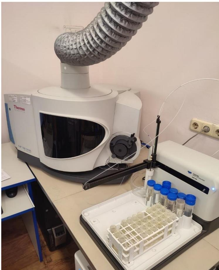
**Принцип работы прибора** основан на измерении величины эмиссии атомов элемента (интенсивности излучения атомов элемента, возникающего при распылении анализируемой пробы в аргоновую плазму, индуктивно возбуждаемую радиочастотным электромагнитным полем) в зависимости от концентрации элемента в образце.
